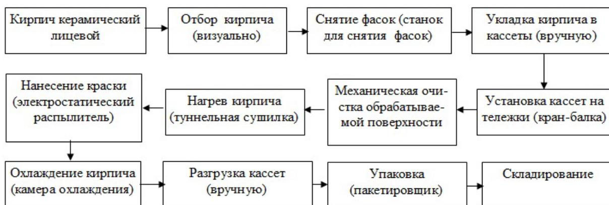
Рис. 4 – Технологическая схема нанесения полимерного покрытия на керамический кирпич
