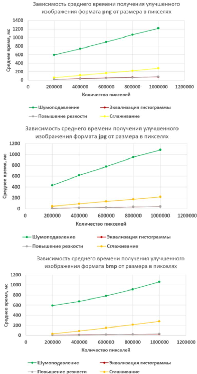
Рис. 2. – Графики зависимости среднего времени получения изображения высокого качества от формата и размера в пикселях
