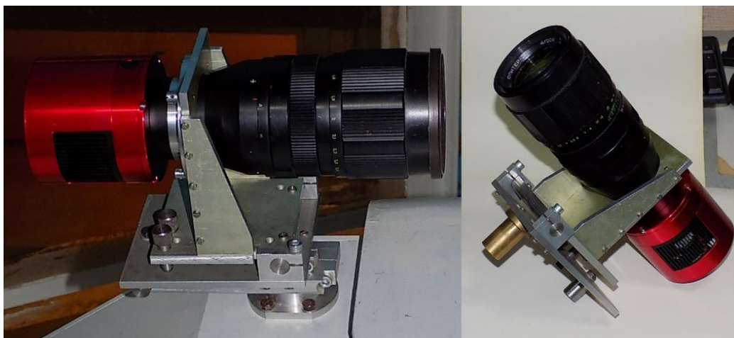
Рис. 1. – Конструкция дополнительного оптического канала в сборе.
