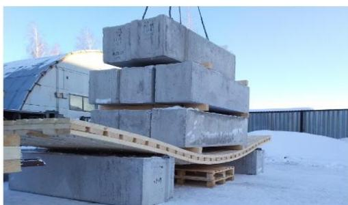
в) Фрагмент загрузки изделия при испытании. (Прогиб составляет 235 мм)
