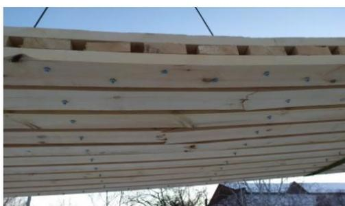
г) Характер разрушения изделия – разрушение отдельных досок
