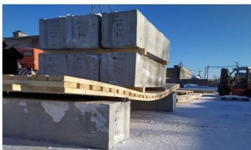
б) Фрагмент загрузки изделия при испытании. (Прогиб составляет 136 мм)
