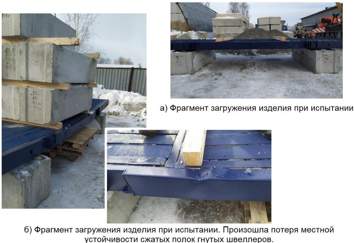
Рис. 4. – Фотофиксация результатов испытания multifunctionальной плиты по типу 2
