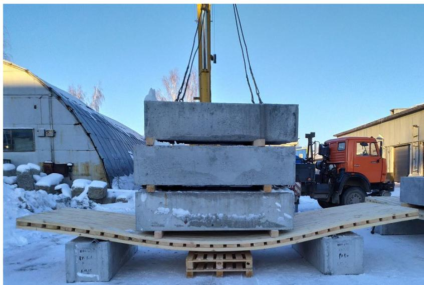
Рис.6. – Деформация плиты в процессе проведения натурных испытаний
