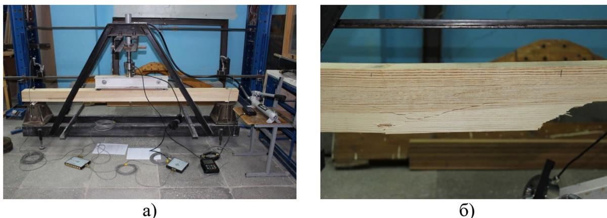
Рис.2. – Испытательный стенд лабораторной модели балки (а) и характер ее разрушения (б)
