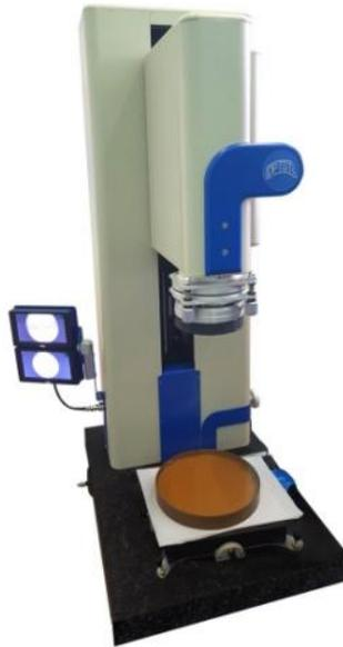
Рис. 1. - Интерферометр OptoTL - 60/125
