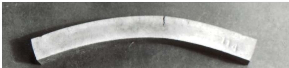
Рис. 6. – Образец, разрушенный при изгибе:
