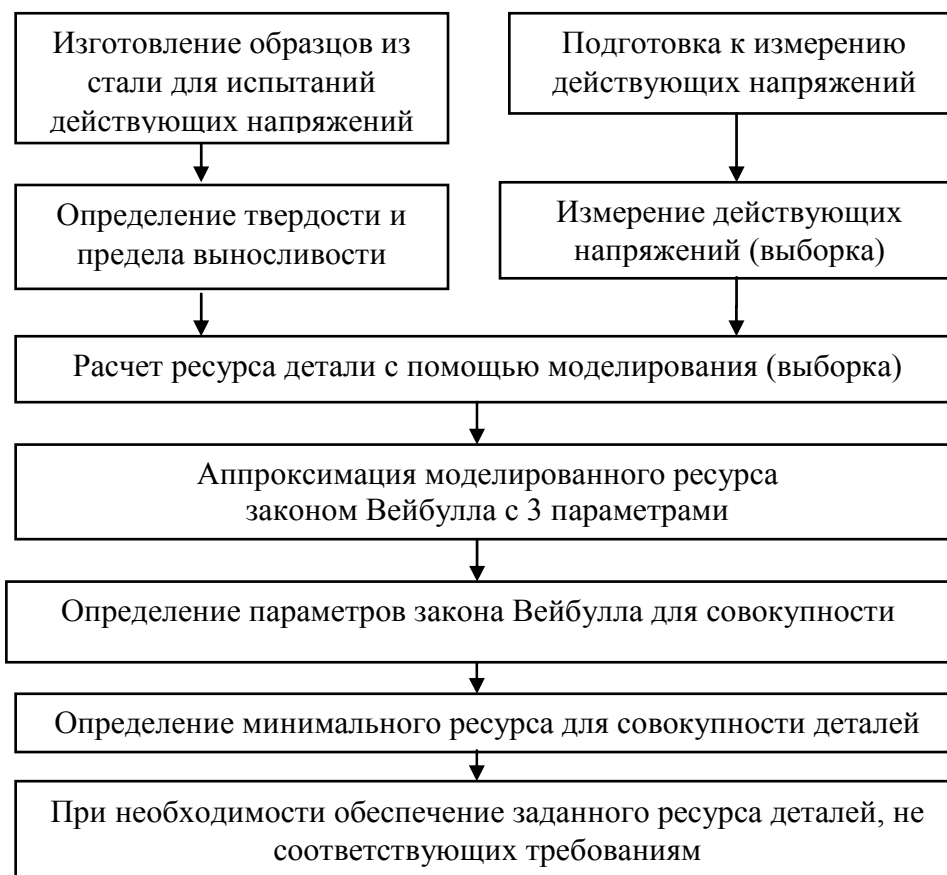
Рис. 3. Алгоритм определения параметров вероятностных распределений выборки и совокупности усталостного ресурса детали.
