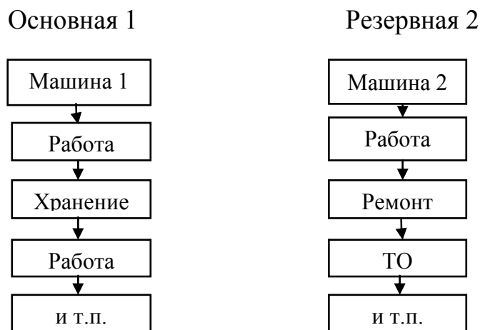
Рис.6. Схема обеспечения надежности основной и резервной машины
