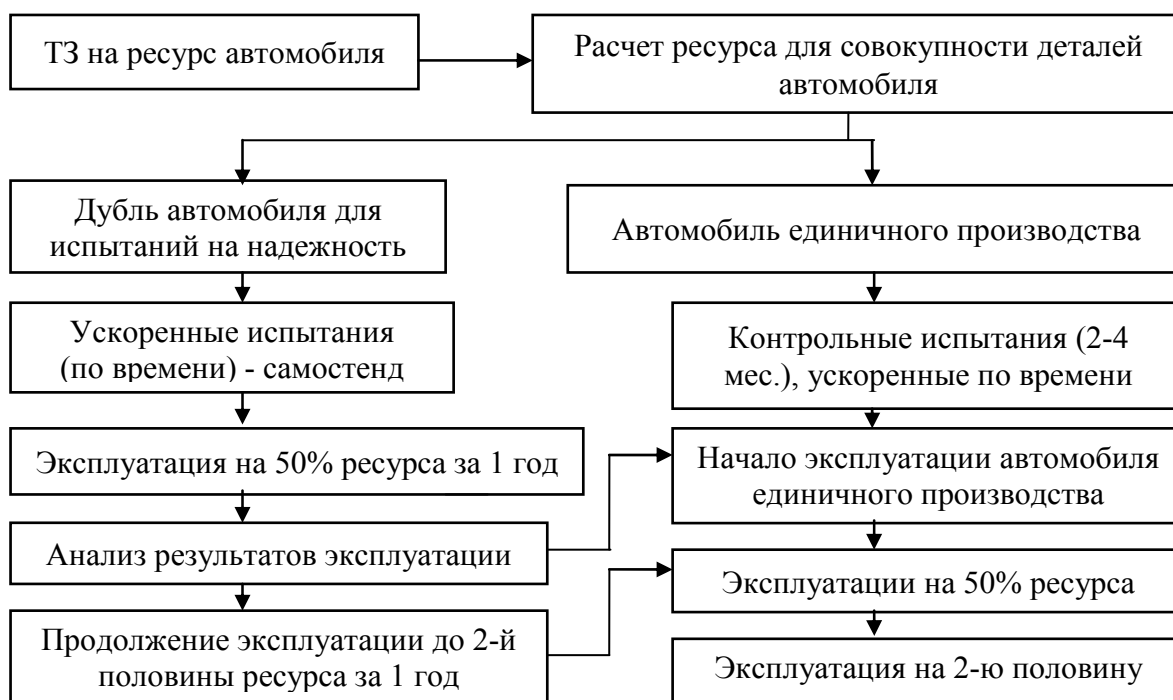
Рис.5. Алгоритм испытания на надежность двух автомобилей
