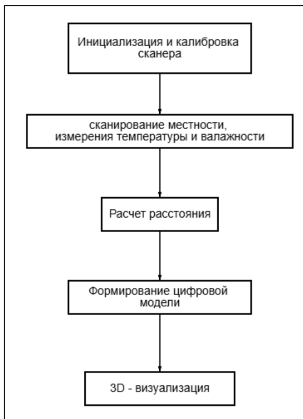
Рис. 6. - Логическая схема модулей работы ПО
