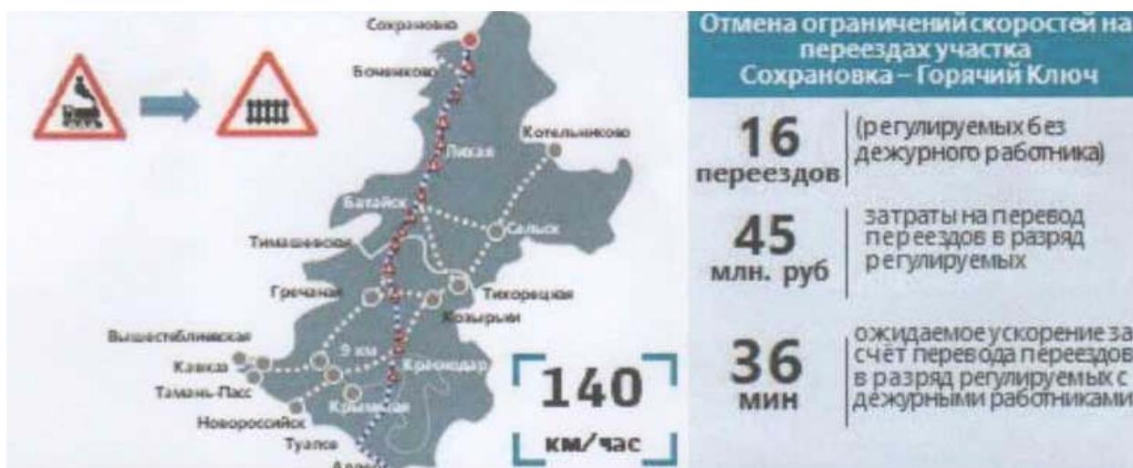
Рис. 3 – Дополнительные мероприятия на участке Сохрановка – Горячий Ключ для увеличения скорости пассажирского поезда до 140 км/ч
