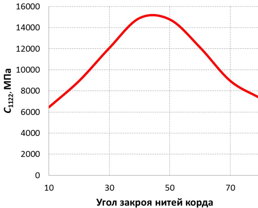
Рис. 3. Зависимость коэффициента  $C_{1122}$  от угла закроя нитей корда.
