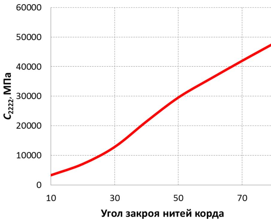
Рис. 5. Зависимость коэффициента  $C_{2222}$  от угла закроя нитей корда.
