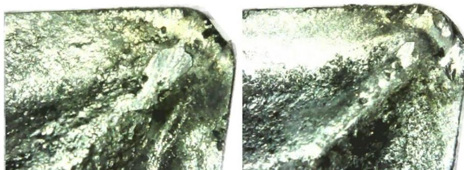
Рис. 4. – Общий вид пластин с покрытиями из никеля и алюминия после испытаний
