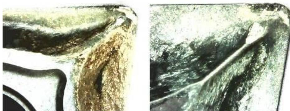
Рис. 3. – Общий вид пластин с покрытиями медью и цинком после механообработки
