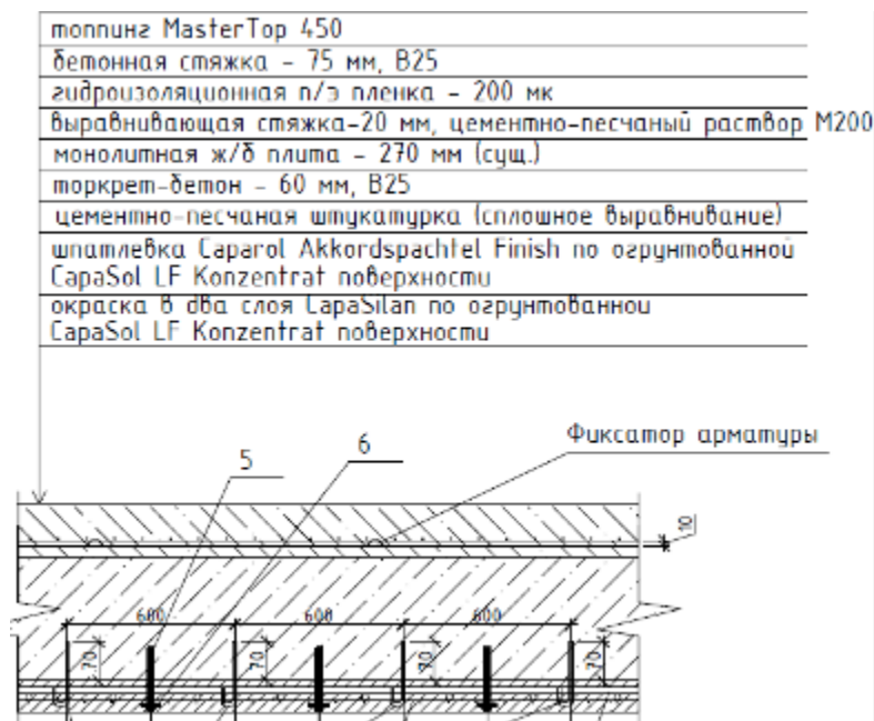
Рис. 4. – Участок плиты перекрытия после усиления
