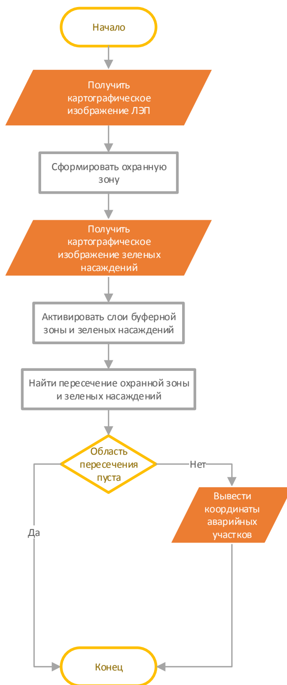
Рис. 1. – Блок-схема алгоритма проведения мониторинга ЛЭП
