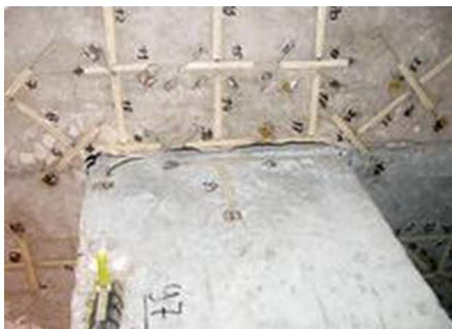
Рис. 2 – Тензорезисторы на бетоне сжатой грани плиты
