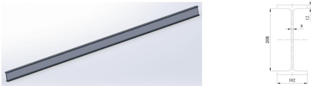
Рис. 2. Общий вид горячекатаной двутавровой балки 20Б3.
