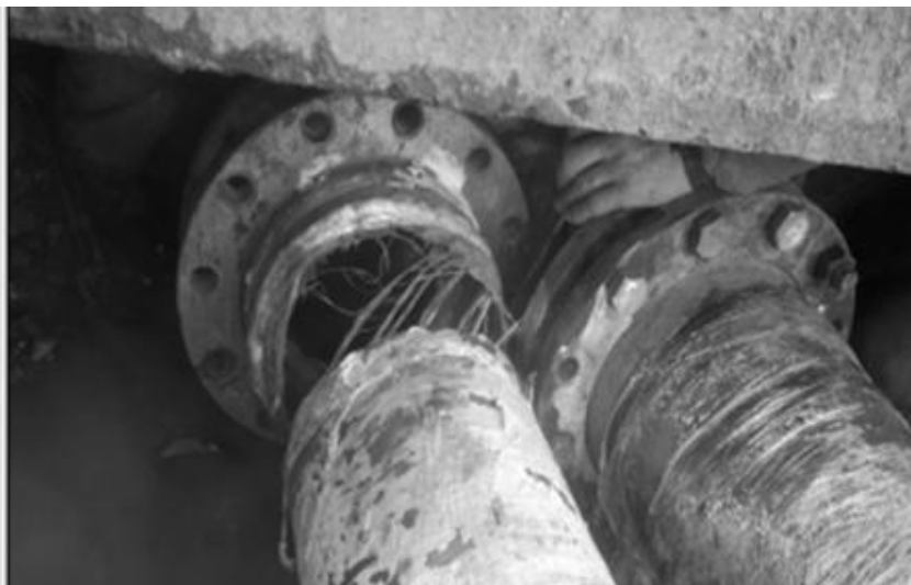
Рис. 3. - Отрыв прямого участка трубы от переходного бурта в месте возврата теплоносителя
