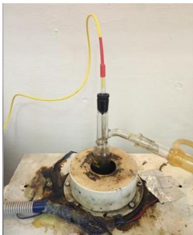
Рис. 3. – Вид температурного датчика в рабочей камере
