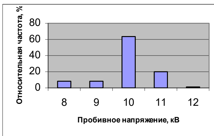
Рис. 2. – Гистограмма распределения значений пробивного напряжения на свече зажигания после запуска ДВС на режиме холостого хода при минимальной частоте вращения коленчатого вала ( n = 650 об/мин)
