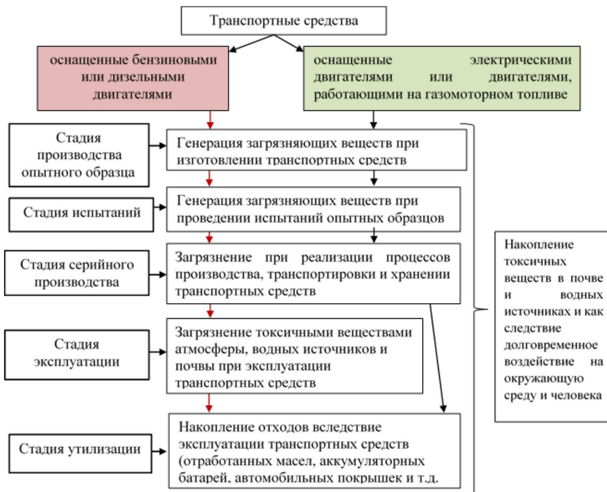
Рис. 2. – Сравнение этапов жизненного цикла транспортных средств и источников загрязнения окружающей среды
