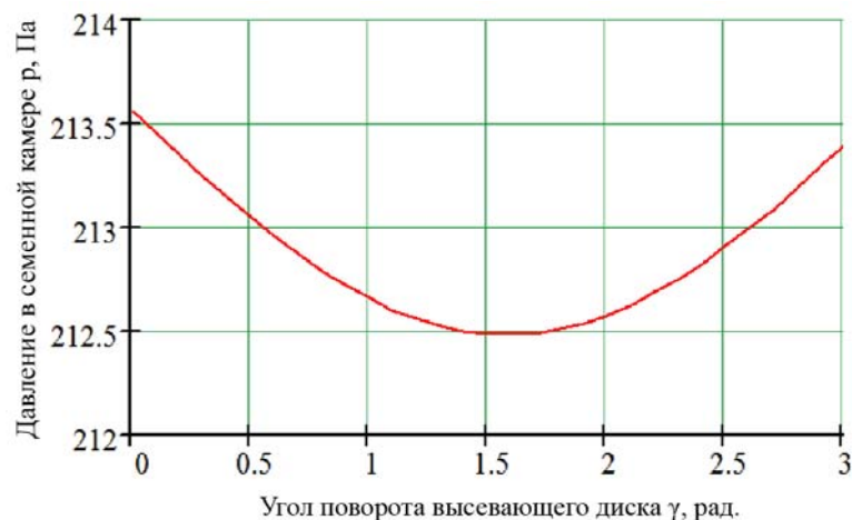
Рис. 3. – График теоретической зависимости избыточного давления p от угла поворота высевающего диска \gamma ( \omega = 0,8 \text{ с}^{-1} , d_{омс} = 4 \text{ мм} )
