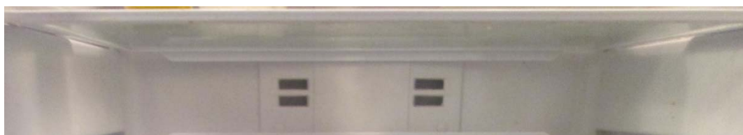
Рис. 2. – Отверстия на задней стенке секции «свежести» для подачи холодного воздуха
