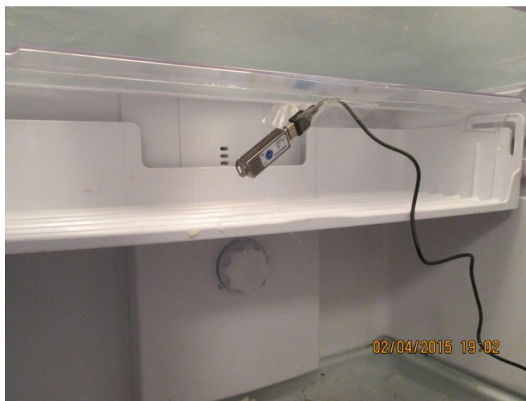
Рис. 3. – Схема установки измерительного прибора в секции «свежести»
