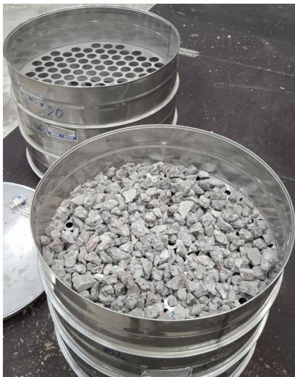
Рис. 2. – Определение гранулометрического состава вторичного щебня
