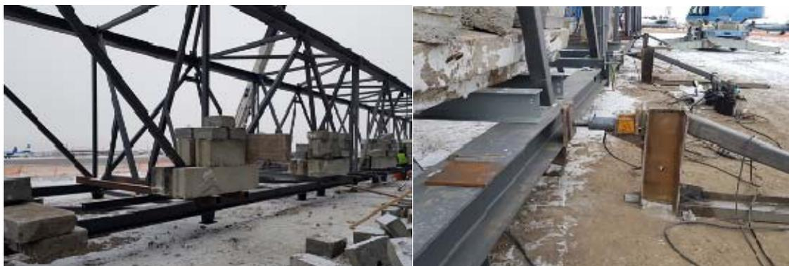
Рис. 5. – Общий вид приложения нагрузок при испытании
