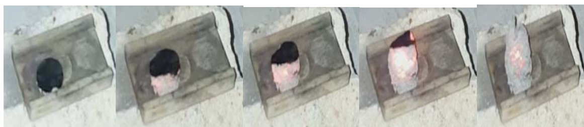
Рис. 1. – Фрагменты самораспространяющейся реакции восстановления серебра для состава 50%LSMO/50%AgNO 3 .
