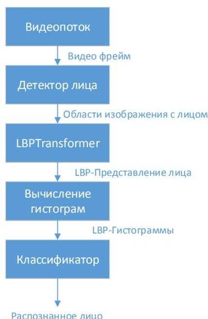
Рис. 1. – Алгоритм обработки данных в системе
