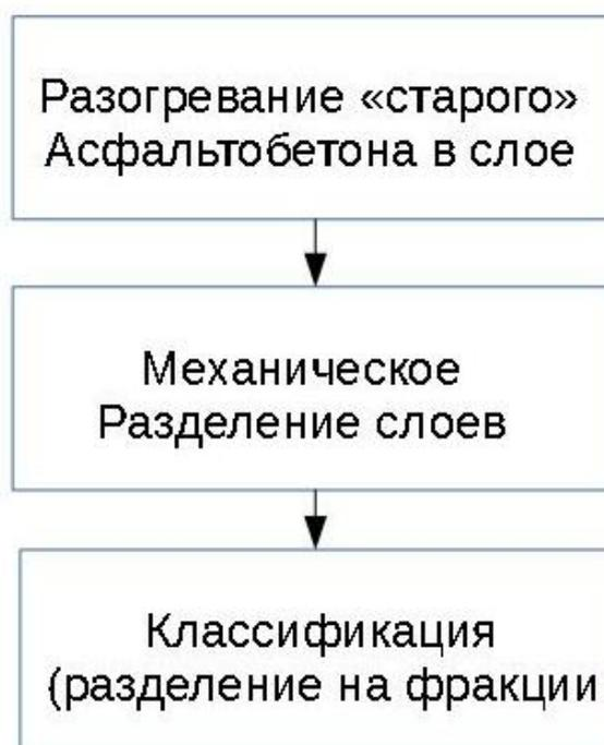
Рис.1- Условная схема тепловой переработки гранулята
