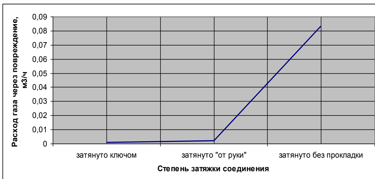
Рис.4. График зависимости расхода утечки газа через разъемное соединение при различной степени затяжки соединения
