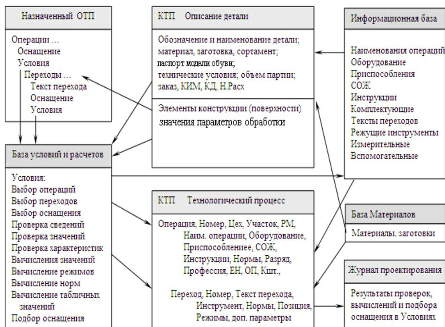
Рис. 5 – Увеличенная схема взаимодействия баз данных в процессе автоматического проектирования ТП производства обуви
