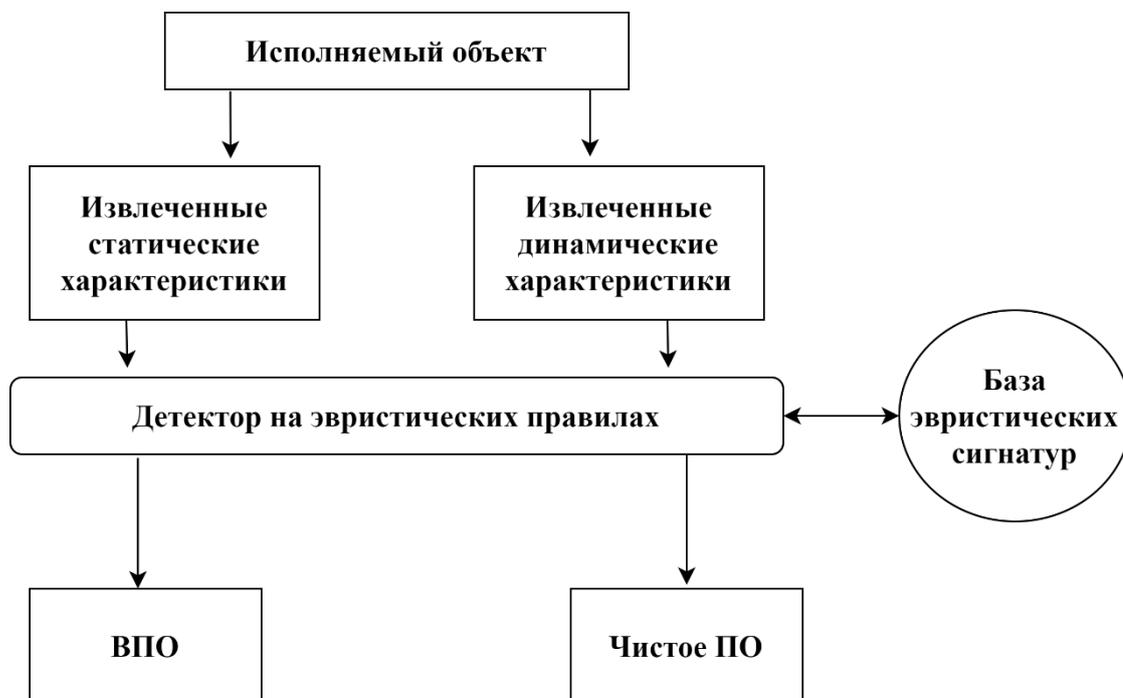
Рис. 6. – Схема обнаружения ВПО на основе эвристических методов
