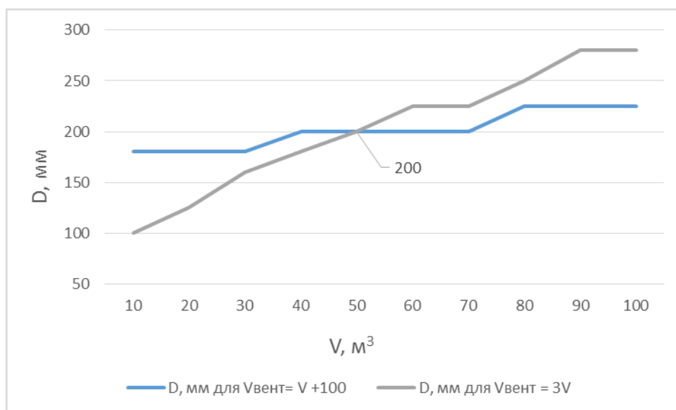
Рис. 2 – График зависимости диаметров вентканалов от объемов газифицируемых помещений при трехкратном воздухообмене в час и при однократном воздухообмене плюс 100 м 3 /ч для скорости движения воздуха равной 1,5 м/с
