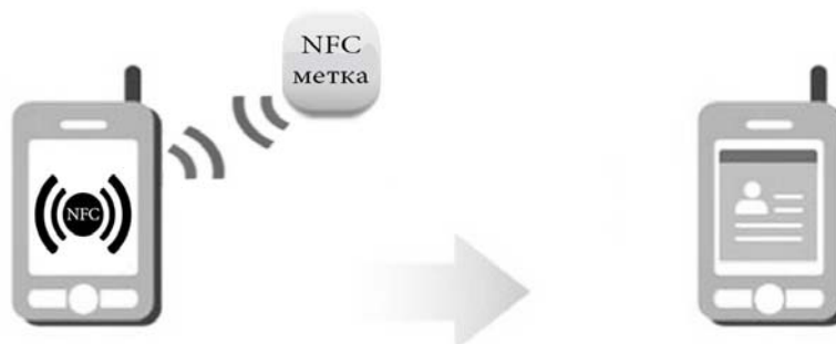
Рис. 2 – Чтение NFC метки и получение уникального кода продукции
