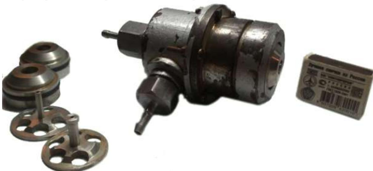
Рисунок 1. Экспериментальная насадка со сменными втулками.
